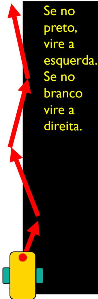
O robô deve escolher para qual lado virar quando o sensor de cor ver uma cor diferente.
